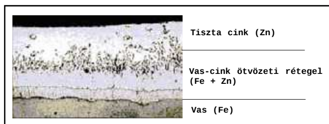
9. ábra: A horganybevonat szerkezete
