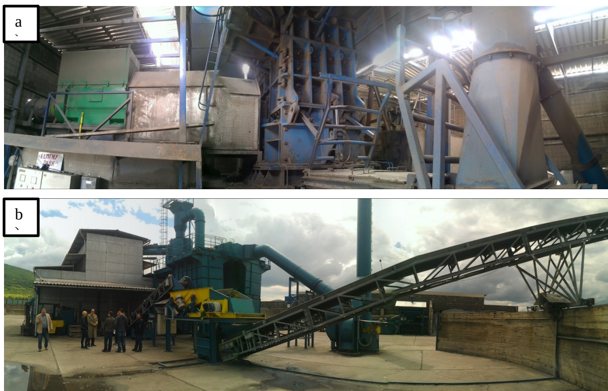
2. ábra Forgó kalapácsos aprítógép (a), ill. a teljes komplexum a hozzátartozó porleválasztó és adagoló egységekkel (b)
