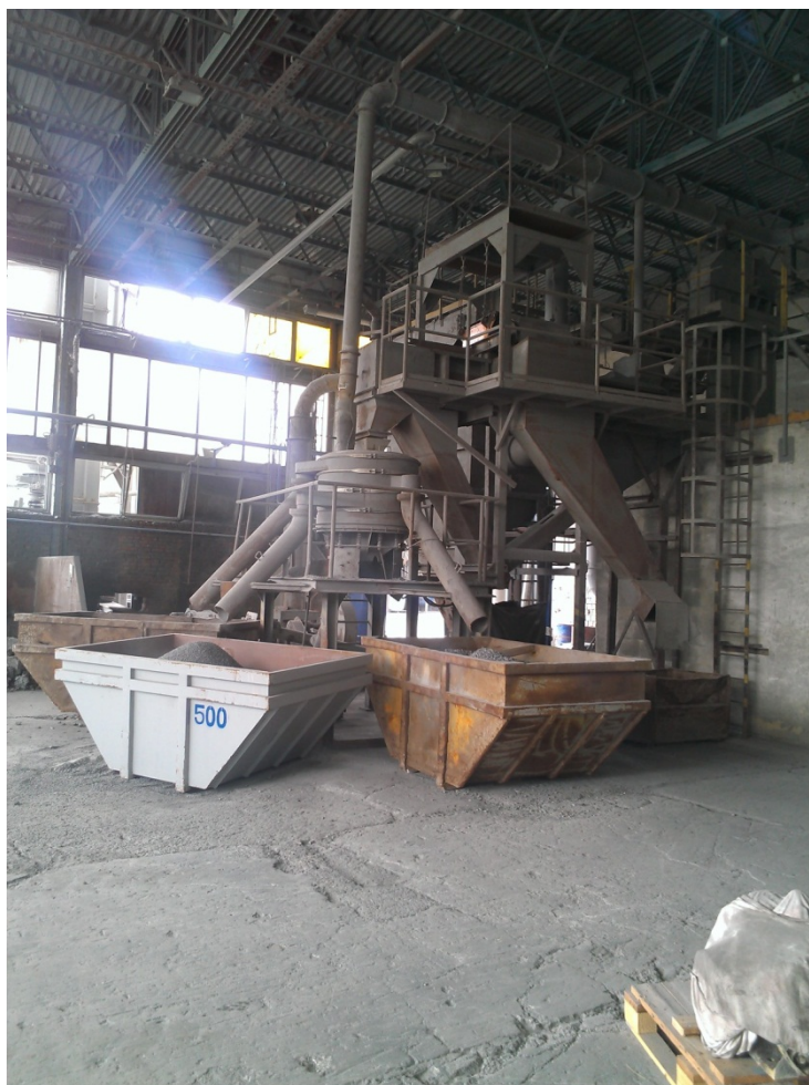
6. ábra A mechanikusan feldolgozott salakok méretszerinti osztályozása
