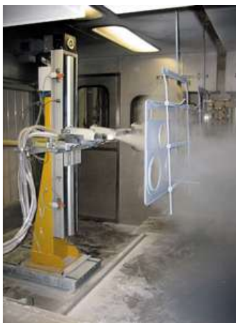
97. ábra Elektrosztatikus zománcpor felvitel [49]
