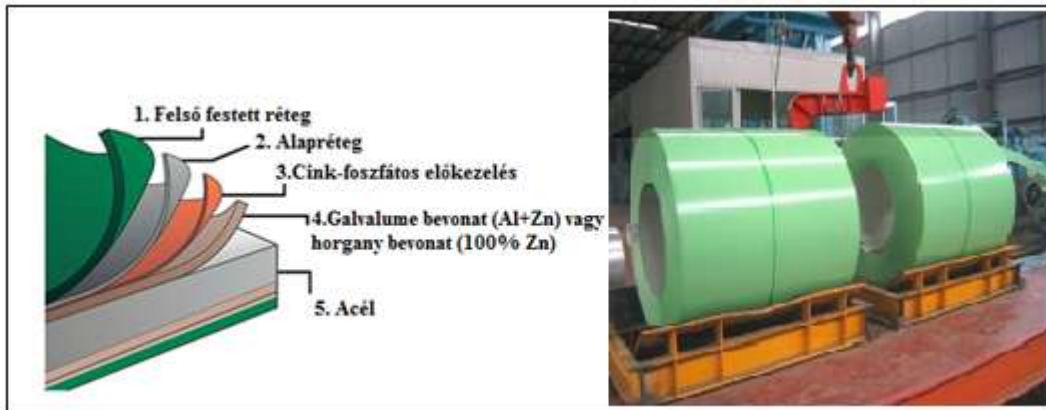
53. ábra Horganyzott, illetve horganyötvözettel bevont acélszalagra folyamatos bevonó soron felvitt bevonati rétegek szerkezete (balra) és színes fedőréteggel festett tekercs
