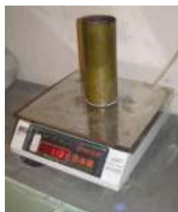
71. ábra A litersúly mérése [39]
