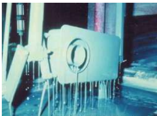
90. ábra Automatizált mártásos zománcozás [34]
