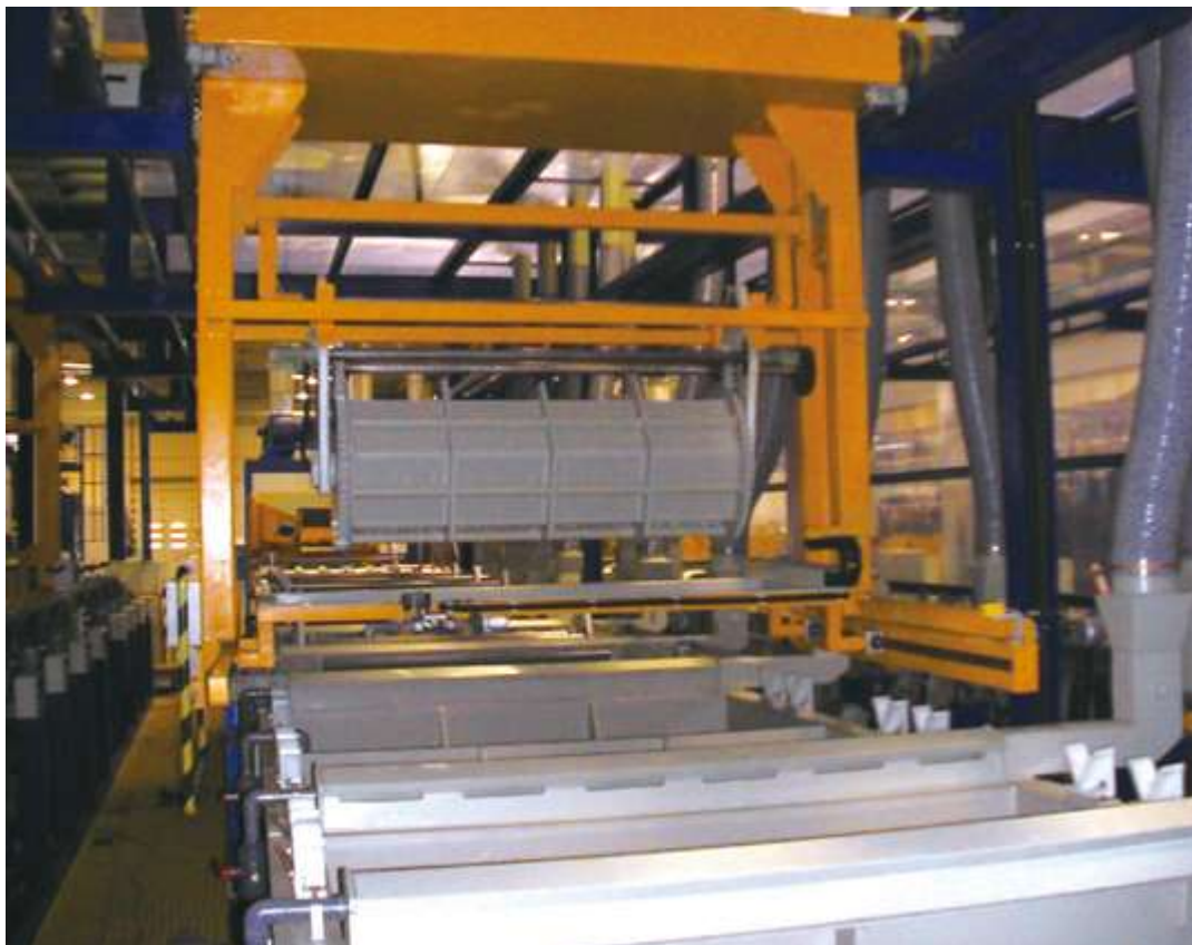
30. ábra Apró alkatrészek galvanizálása darura függesztett és daruval mozgatott perforált dobozban
