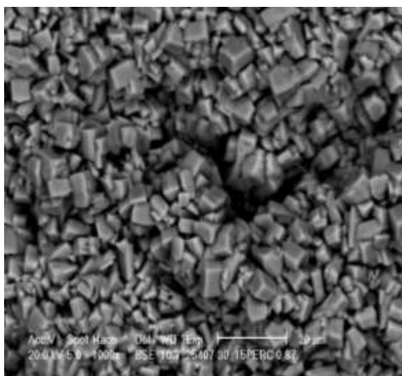
9. ábra Ipari fürdőből /Granodine 3020/ 15 perc alatt leválasztott finomkristályos foszfátréteg elektronmikroszkópos /SEM/ felvétele (Méretvonal hossza: 20 µm)
