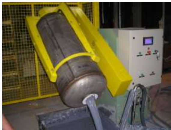
94. ábra Zománcozás kipörgetéssel [48]
