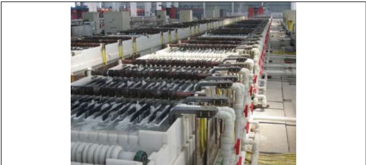
37. ábra Folyamatos huzalgalvanizáló sor elektrokémiai kezelő kádjainak fényképe. Az egymás mellett párhuzamosan futó huzalok között láthatók a függesztett ellenelektrodok (anódtáblák). A kádak melletti műanyag csövezetéseken keresztül áramoltatják a fürdőfolyadékot
