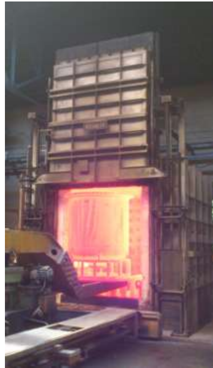
101. ábra Sugárzócsöves borsz-kemence [39]
