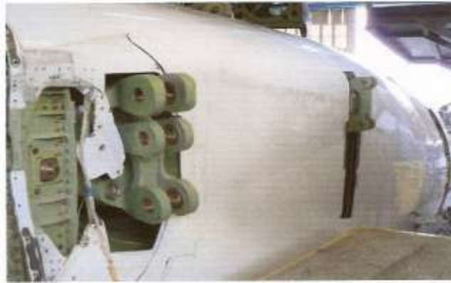
59. ábra B-737-es repülőgépszárny csatlakoztatásának módja [42]
