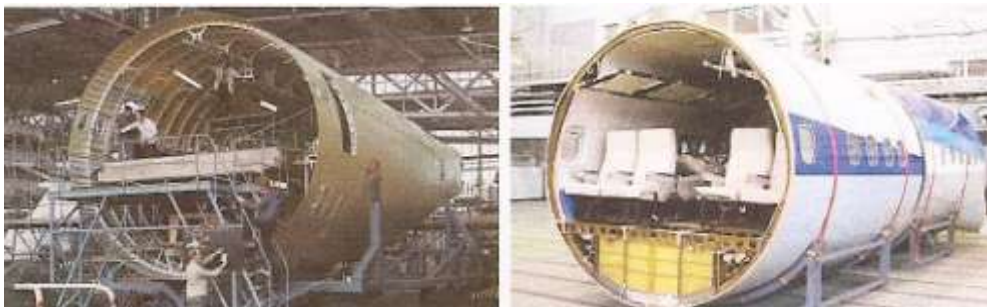
58. ábra Acéltartókkal erősített utasszállító repülőgéptörzs kialakítása [42]
