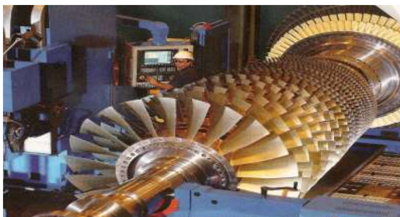
48. ábra Hőálló acélból készült gázturbina forgórész [33]
