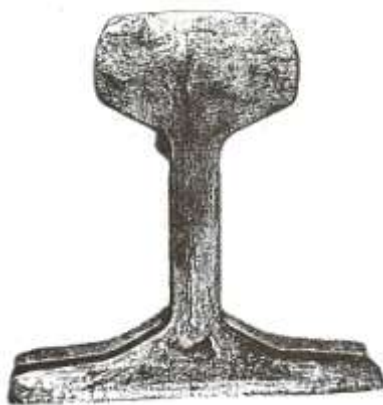
40. ábra Diósgyőrben 1875-ben kétszer forrasztott technológiával gyártott sín makro-csiszolata [28]
