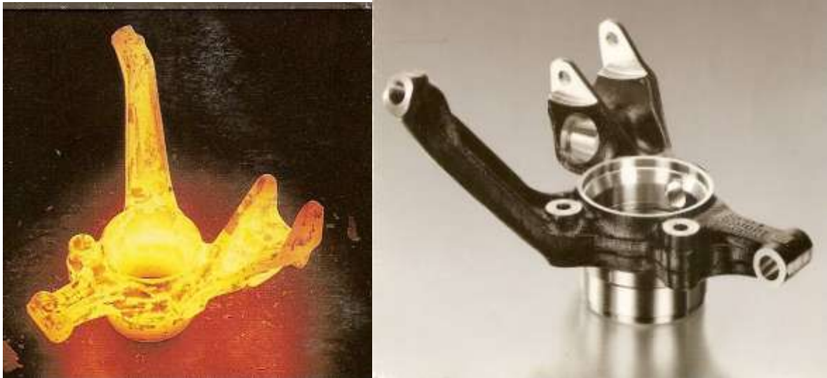
26. ábra Süllyesztékes kovácsolással készült kapcsolóvilla [23]
