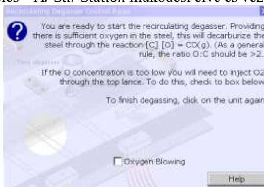
4.13 a-b. ábra Részletekben vákuumozó berendezés – Recirculating Degasser működési elve és vezérlő képernyője
