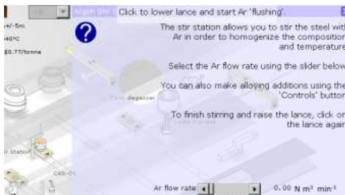
4.12 a-b. ábra A felső argonos kezelés – Ar Stir Station működési elve és vezérlő képernyője
