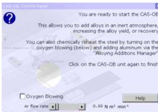
4.11a-b. ábra A kémiai hevítés – CAS-OB eljárás működési elve és vezérlő képernyője
