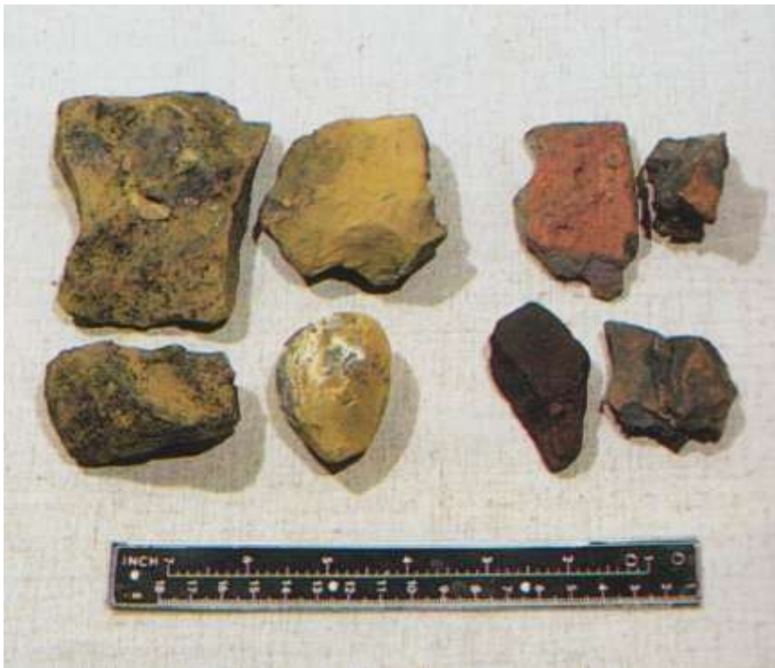
(3.2. ábra) Pörkölt és pörköletlen gyepvasérc-darabok 8-10. századi hazai lelőhelyekről [3.6]
