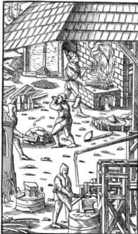
A - kemence; B - elegyőbű; C - székelyfű; D - szűz; E - fakalapács; F - vaspöröly; G - állí
