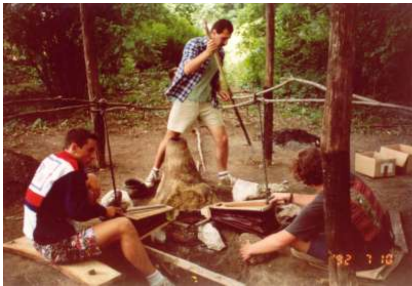
(5.58. ábra) Kettős fújtatás nemeskéri típusú, reprodukált bucakemencével elvégzett próbaolvasztáson – Sopron 1992. [5.37]
