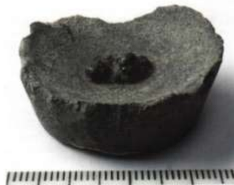
(4.27. ábra) Kupellációs tégely csonthamuból készült alja (London) [2.26]
