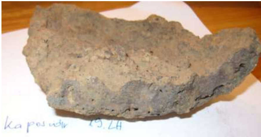
(5.42. ábra) A medence alakjában megdermedt salak (medve) – Kaposvár 7-9. sz. (saját fotó)
